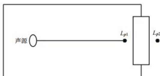
图 11 室内声源等效为室外声源图例
